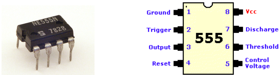
Figura 1. Encapsulamento do CI 555 e identificação dos pinos
